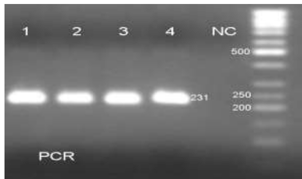
شکل ۱. نتیجه الکتروفورز محصول PCR با اندازه bp ۲۳۱ (چاهک ۱ تا ۴). چاهک ۵ نمونه کنترل منفی و چاهک ۶ مربوط به Ladder 50bp (Fermentas) می باشد.
