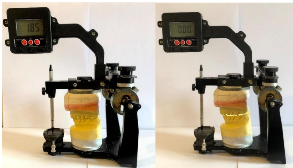
شکل ۳. اندازه‌گیری تغییر Inclination بازوی فوقانی آرتیکولاتور توسط شیب سنج دیجیتال پس از جابه‌جایی فوقانی واحد ماگزایلا
