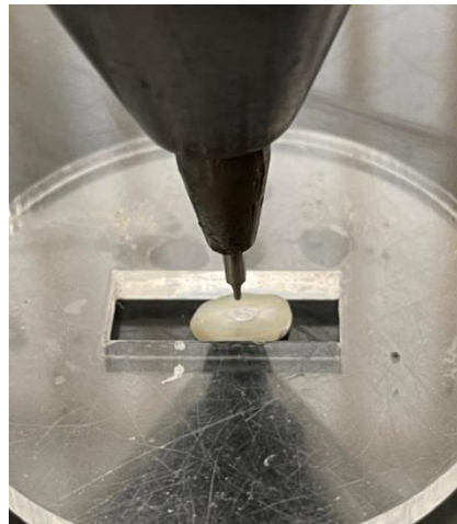
شکل ۱. انجام تست استحکام باند push out بر روی نمونه‌ها
