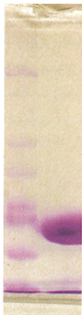
شکل ۴. الکتروفورز SDS-PAGE مخلوط فراکسیونهای خروجی کروماتوگرافی G-200 (I) و استاندارد وزن مولکولی پروتئینها (II)
